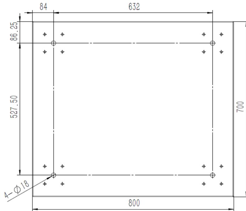
图 22 低压柜体底部预留安装孔尺寸
