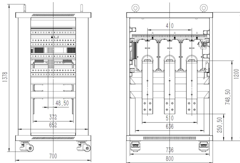
图 5 600A~2000A (含) 低压传感器测量柜安装指标距离
