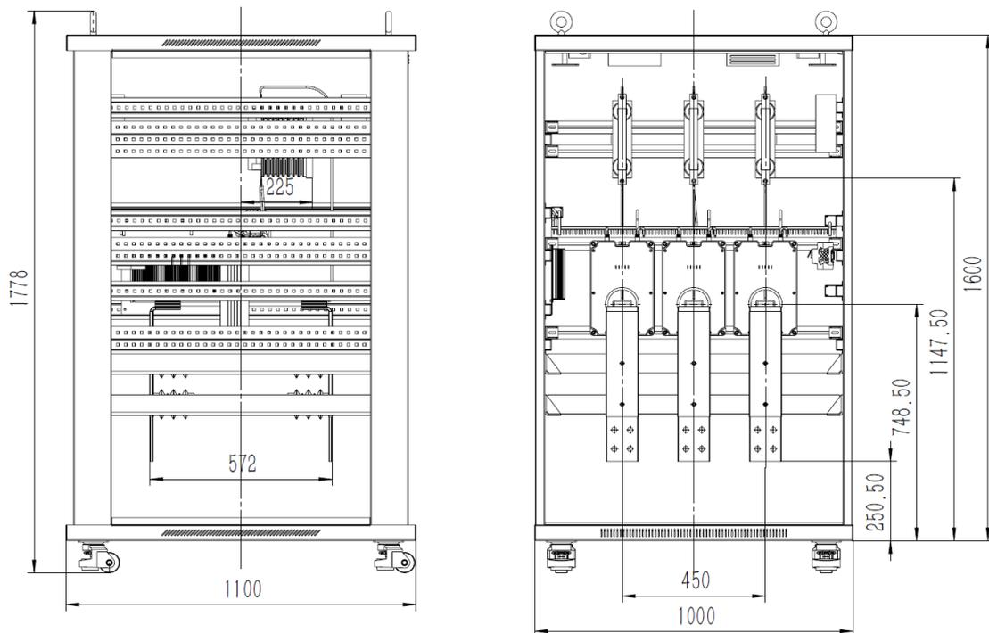
图 11 600A (含) ~2000A (含) 高压传感器测量柜元器件安装指标距离
