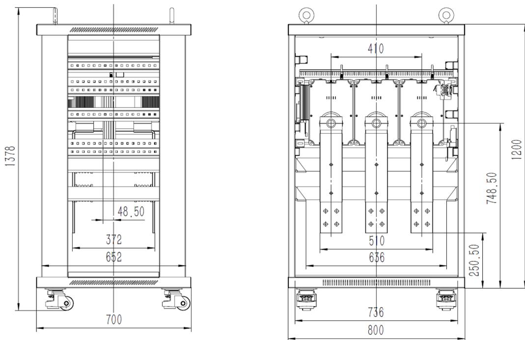
图 72000A~3000A (含) 低压传感器测量柜元器件安装指标距离
