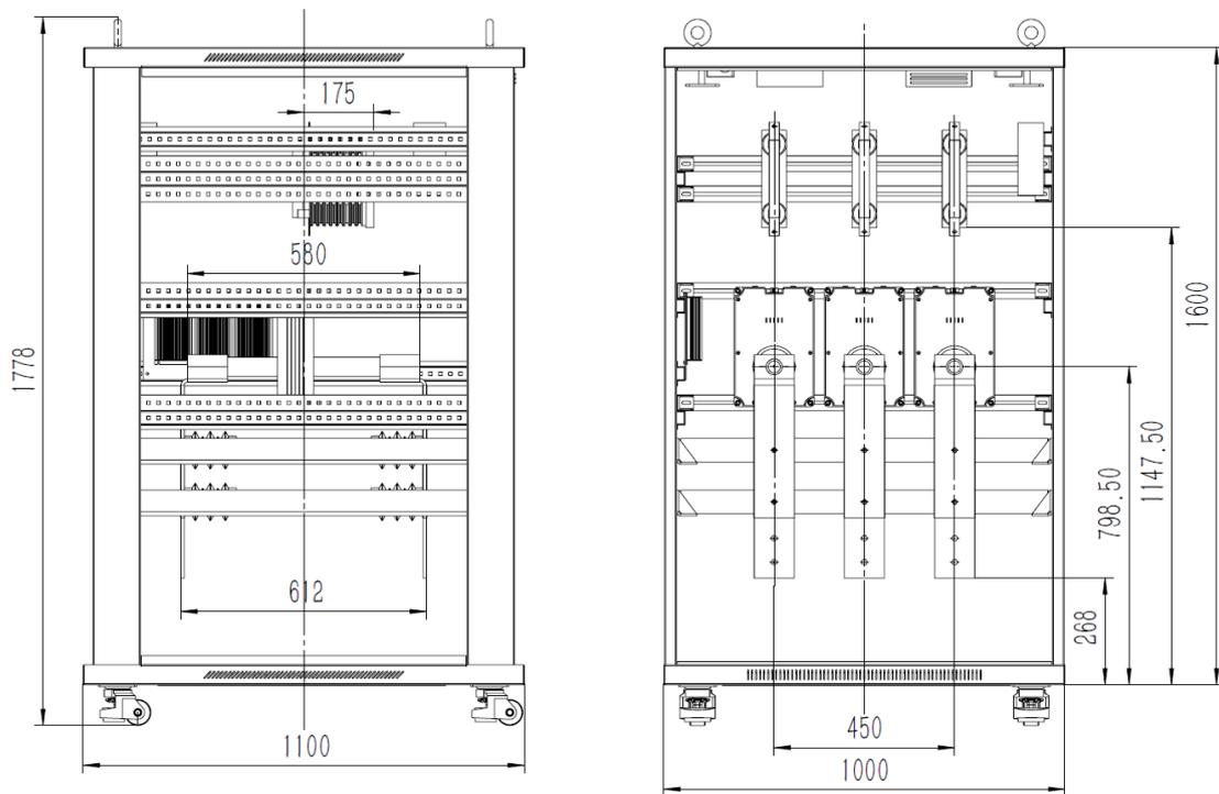
图13 2000A (含)~3000A (含) 高压传感器测量柜元器件安装指标距离
