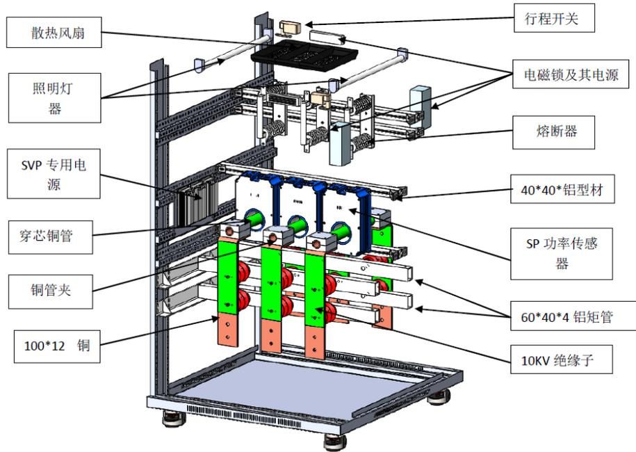
图12 2000A (含)~3000A (含) 高压传感器测量柜元器件布局设计
