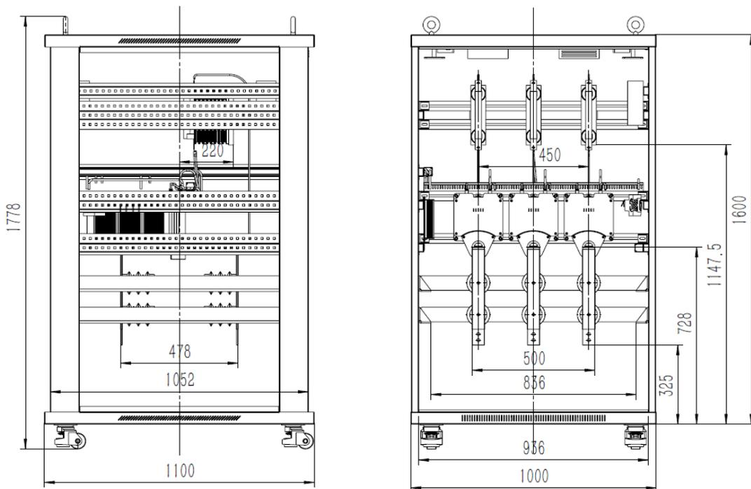
图9 600A 以下高压传感器测量柜元器件安装指标距离
