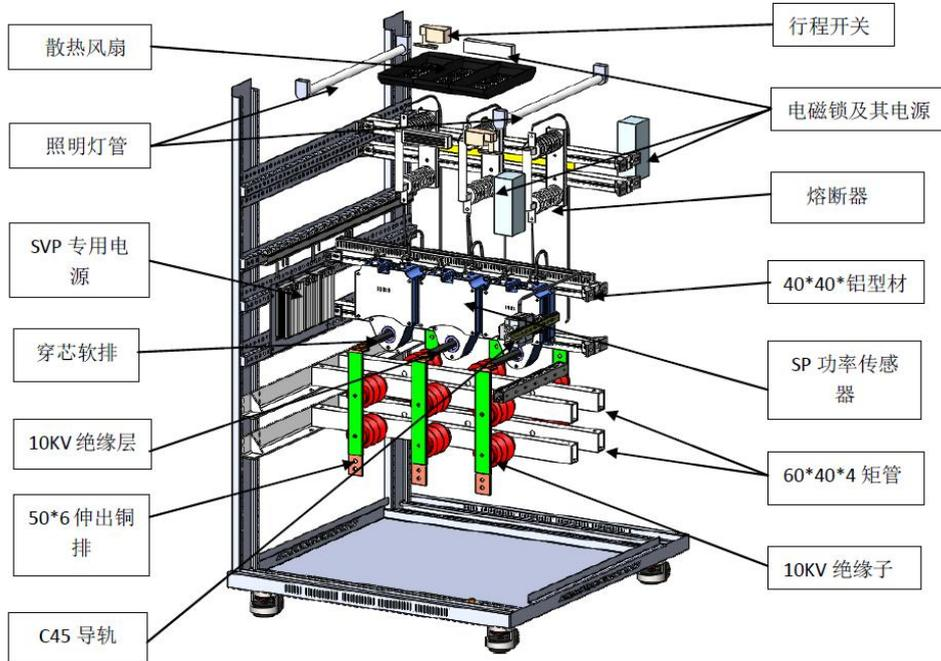
图8 600A 以下高压传感器测量柜元器件布局设计
