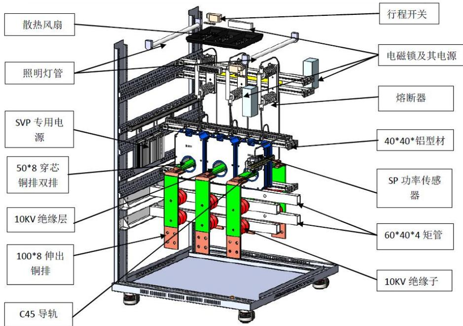
图 10 600A (含) ~2000A (含) 高压传感器测量柜元器件布局设计
