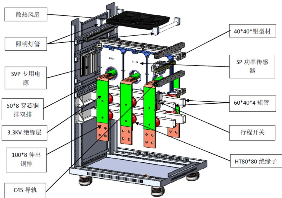
图 4 600A~2000A (含) 低压传感器测量柜元器件布局设计
