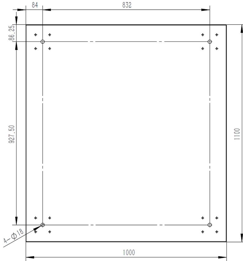
图 21 高压柜体底部预留安装孔尺寸
