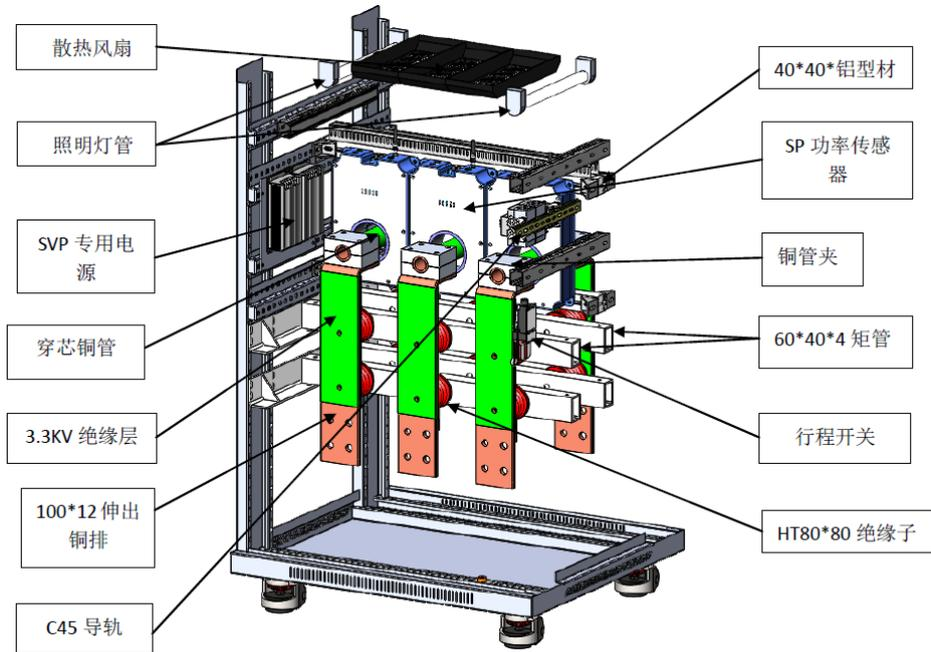
图 62000A~3000A (含) 低压传感器测量柜元器件布局设计
