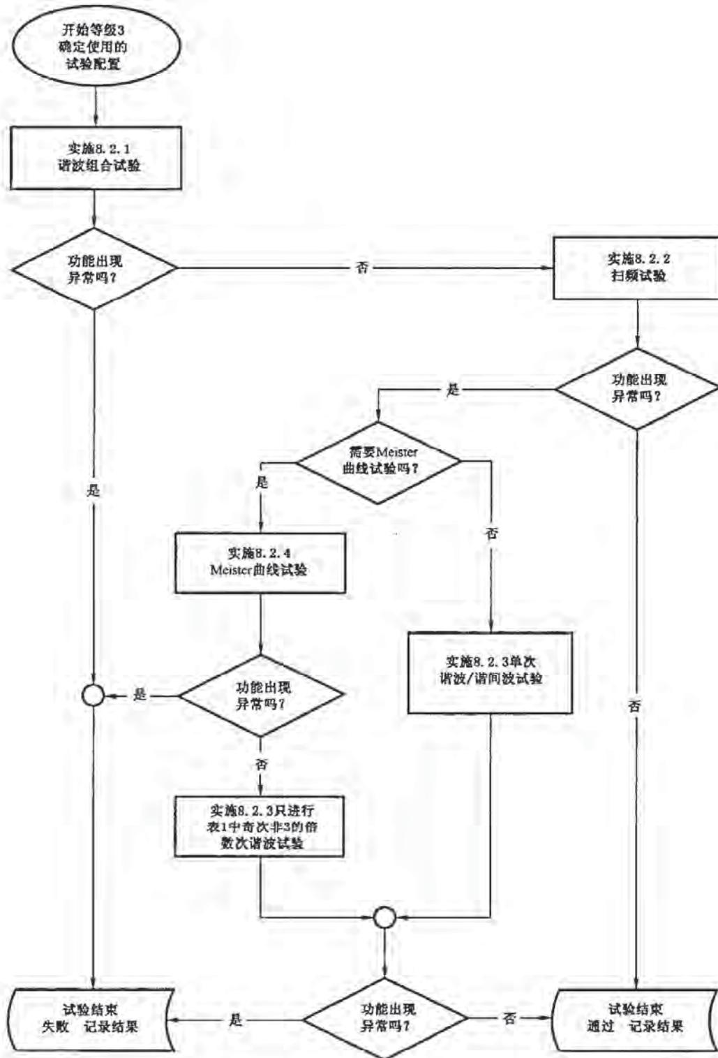
图 1b) 等级 3 的试验流程图
