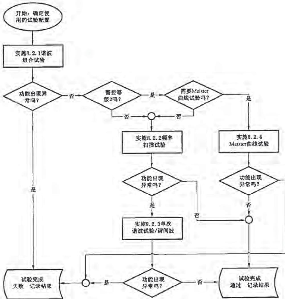
图 1a) 等级 1 和等级 2 的试验流程图
