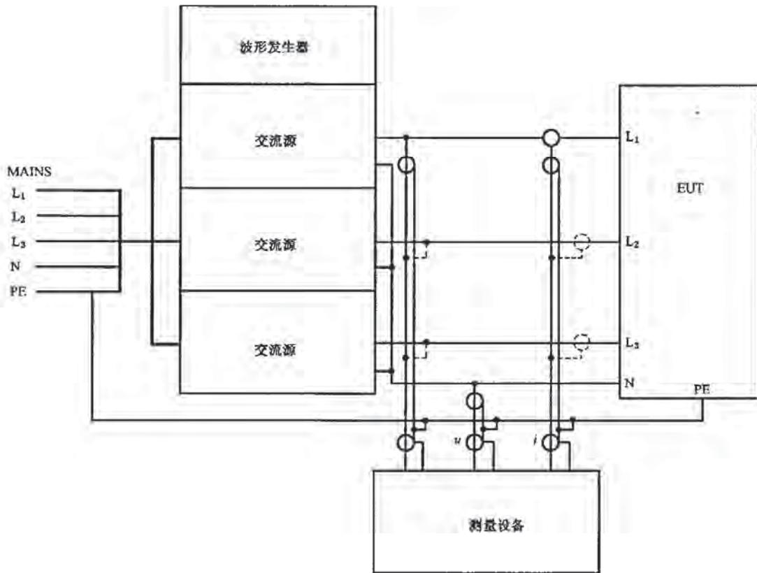
图 3 三相 EUT 试验布置举例
