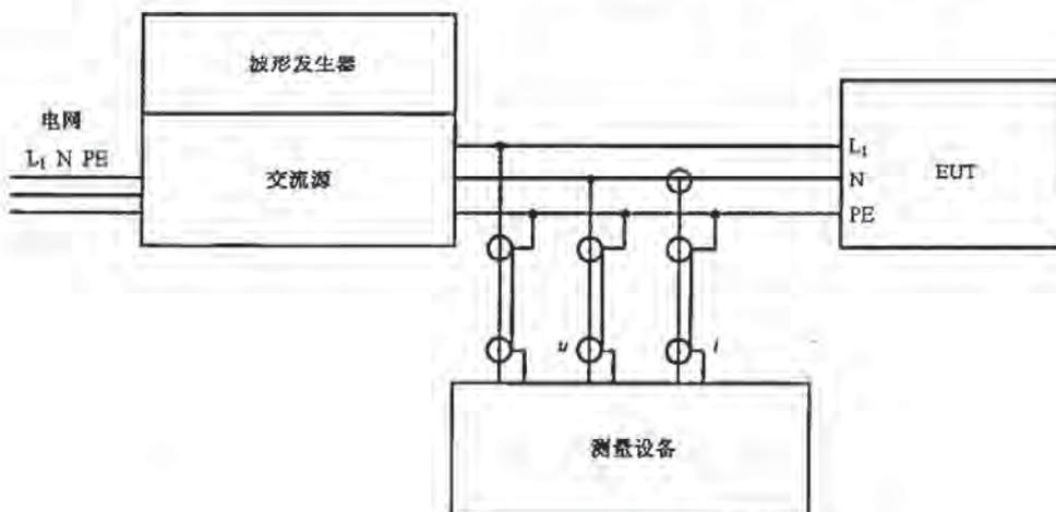
图 2 单相 EUT 试验布置举例
